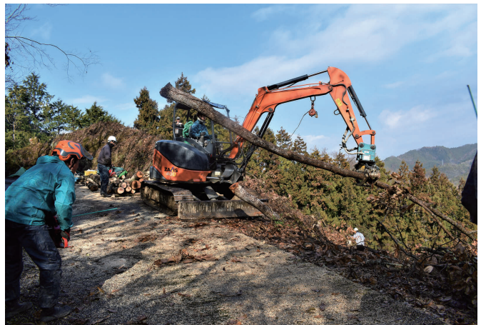
近くまで引き寄せた原木をグラップルでつかみ、平地の作業スペースに移動
