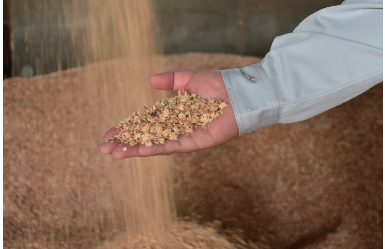
これがザラメ。チップパーの刃の調整でチップのサイズを変えられる
