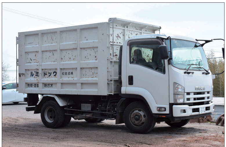
小規模生産者向け配送用トラック。1度に10立米のおが粉・チップを輸送できる（梅本氏提供）
