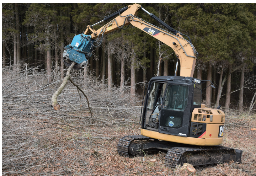
多方向に折り重なる長い原木を扱うにはコンマ2以上のバックホーとグラップルが有効
