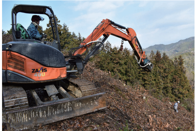
傾斜地に元倒しされた原木にワイヤーをかけ、ウインチで引っ張り上げる。ワイヤー作業を行うのは高橋氏の父・茂行氏
