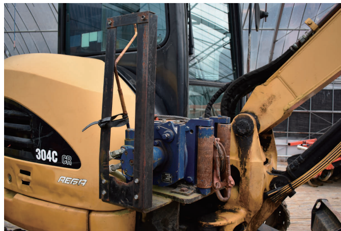
急峻な場所で倒した原木を引き上げるためのウインチ
