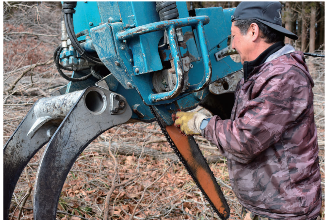
ソーのメンテナンス。機器への造詣の深さ、経験も重要
