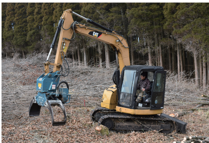
コンマ3のバックホー（CAT 308DCR）＆グラップルソー（イワフジGS-65LSJ）
