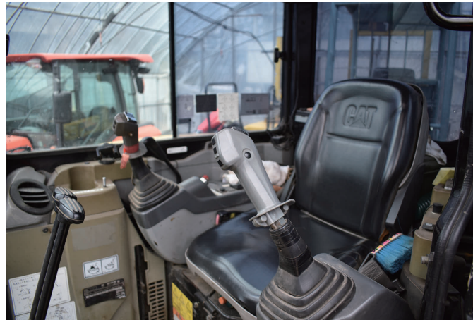
全ての操作を手動で行えるバックホーの運転席。これは倉庫用ハウスに置かれたコンマ2（4tクラス）のもの。現在、武石氏は林業用の13 tクラスを含め3台を所有
