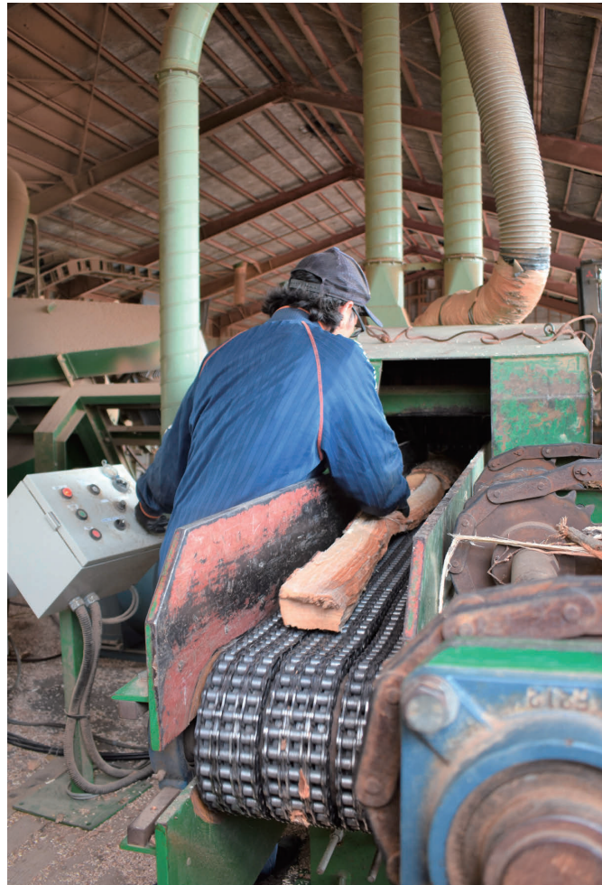
チッパーにクヌギ材を投入しおが粉を製造。スタッフ1人でのオペレーションが可能
