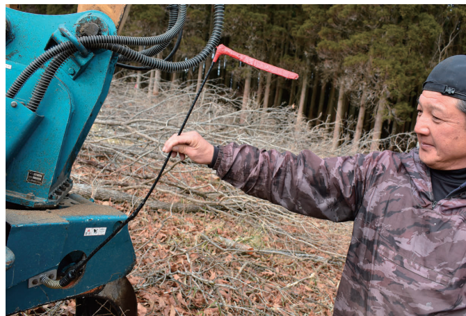
決まった長さに玉切るための定規は、折れにくく曲がりにくいグラスファイバー&スプリングのお手製
