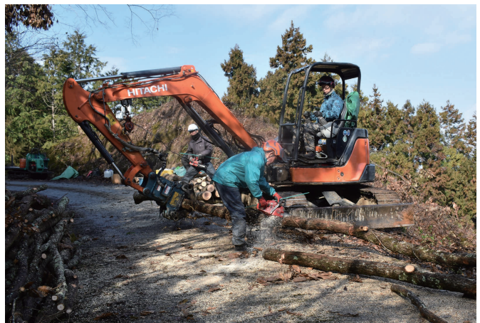
チェーンソーを駆使し、枝を落とし、一定の長さに玉切り。作業が行いやすいようグラップルで原木を固定している
