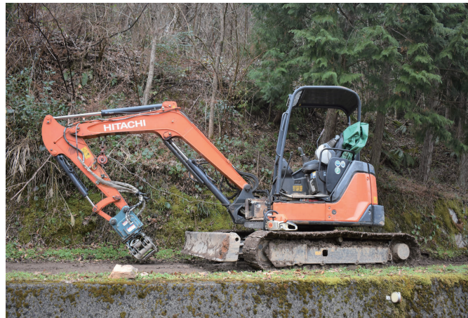
高橋氏が所有する4tクラスのバックホー日立建機ZX40US5B。グラップルはイワフジGS-40LJVで、ウインチはイワフジTW-1B
