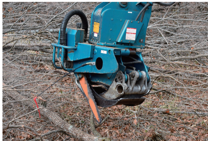
セットされたソーは切断位置を左右に15cmほどスライド調節できるアジャスト機能付き
