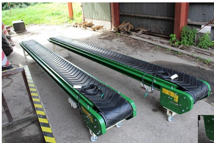
導入したベルトコンベア2基
