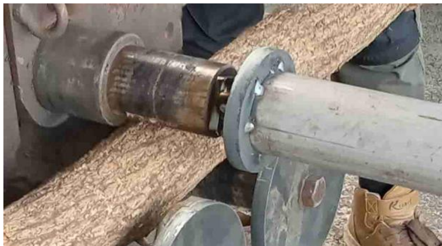
3本軸ロール機による圧迫剥皮1
