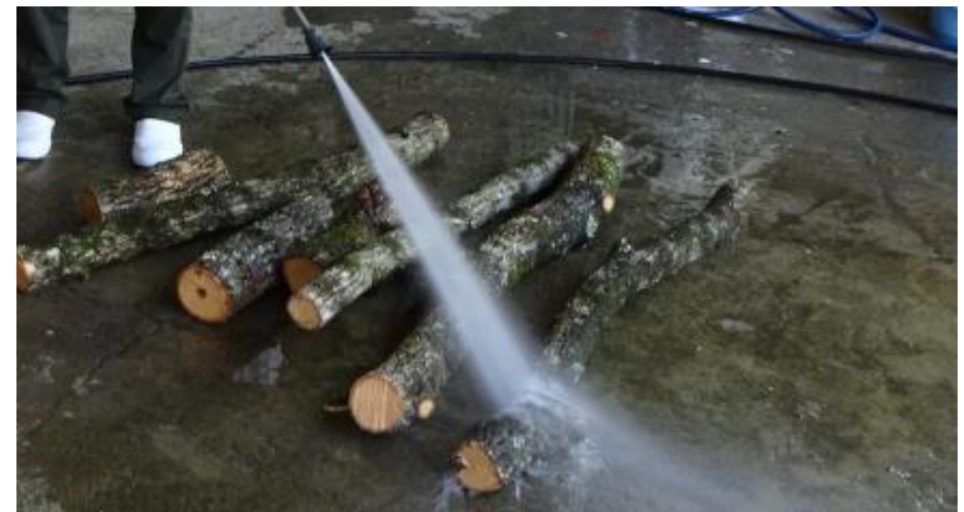
変圧式高圧洗淨機による洗淨試験
