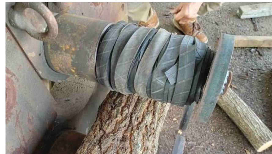
3本軸ロール機による圧迫剥皮2
