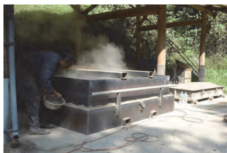
蓋と消し台との隙間をスパイでシールする
