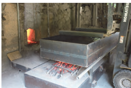
蓋をかぶせ、窯前から移動させる
