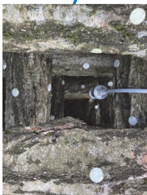
【温湿度センサー】 ほだ場及びハウス内外の温度・湿度を計測する(2系統)
