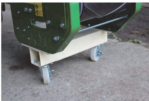
脚まわり加工（段&ローラー設置）
