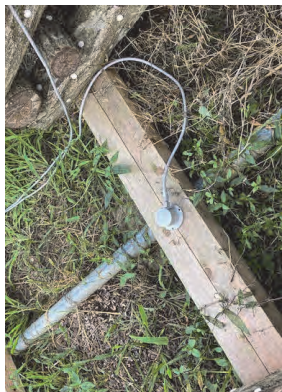
【日射量センサー】 ほだ場及びハウス内の日射量を計測する
