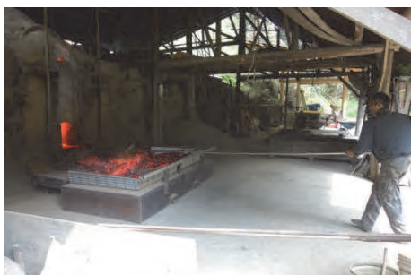
かすりとサレを使用し、炭を引き寄せる
