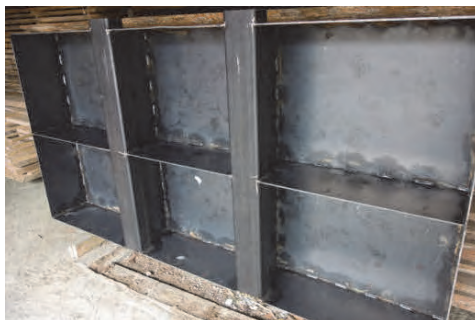
裏面に補強板を入れ強度を増した
