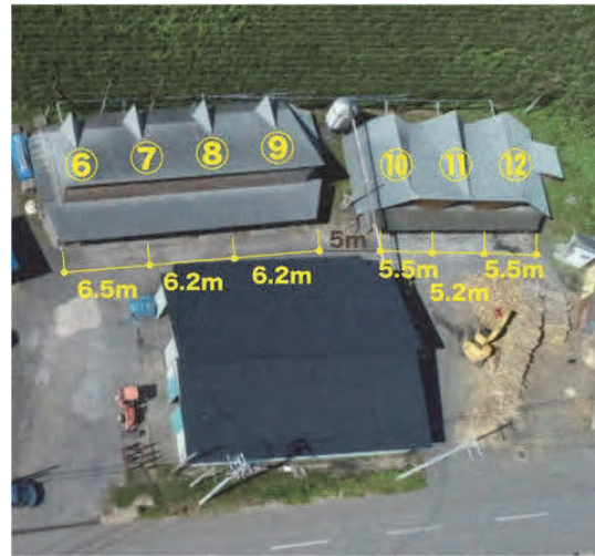
詳細図（窯のサイズ及び距離等）
