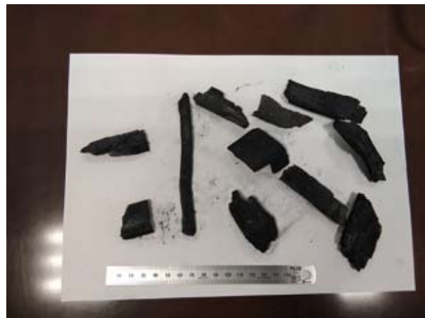
図IV-6 四街道市掘り穴式開放型炭化方法
