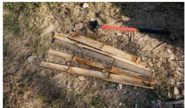
図Ⅲ-24 ハンマーで節を叩いて割れた竹
