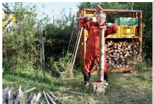
図Ⅲ-23 鋼鉄製竹割り器を使った竹割り
