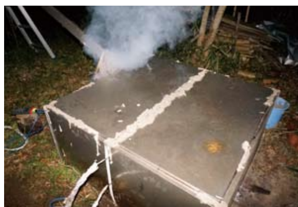
図Ⅲ-31 水で練った木灰での目止め
