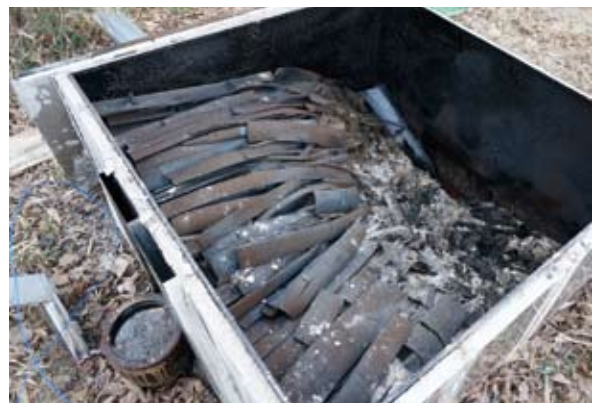
図III-35 3日間経過し完全に炭化炉が冷えてから炭を出す。左下は採取した竹酢液
