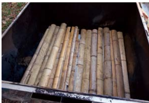
図Ⅲ -29 炭材の詰め込み。手前が排煙口
