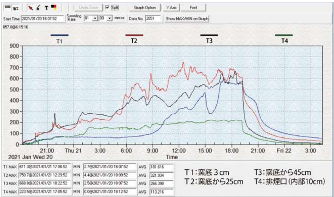
図IV-5 大網白里市の可搬型密閉式炭化炉「簡単スミヤケール」による炭化温度の推移 (T1:黒、T2:赤、T3:青、T4:緑)
