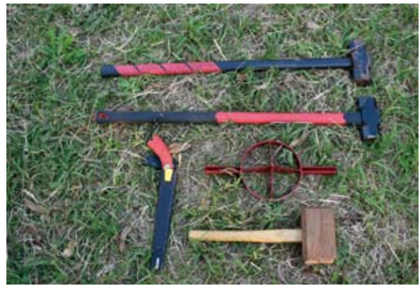
図Ⅲ-22 竹を割るための道具。上からハンマー(8ポンド)、同(6ポンド)、ノコギリ(左)、竹割り器(4分割・鋼鉄製)、片手掛矢
