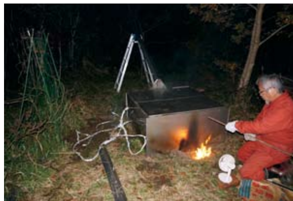
図Ⅲ-30 口焚き。小型扇風機で熱風を炉内に送り込む
