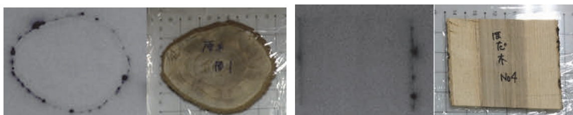
図2 原木（左）およびぼだ木（右）の IP 解析画像
