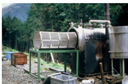
土場に設置された横型移動式精油採取装置
